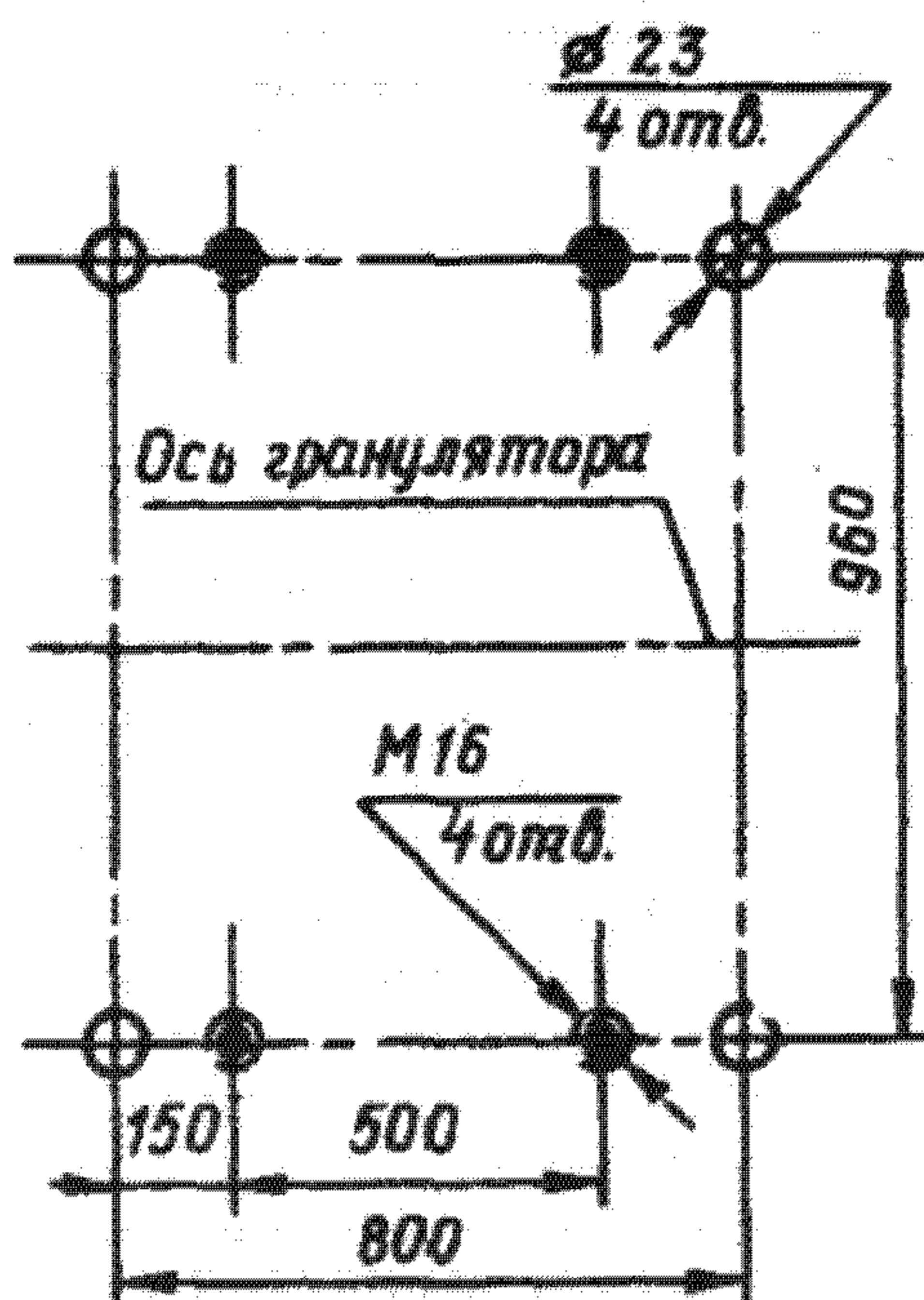
Рис. 34.12. План расположения отверстий под фундаментные и отжимные болты
