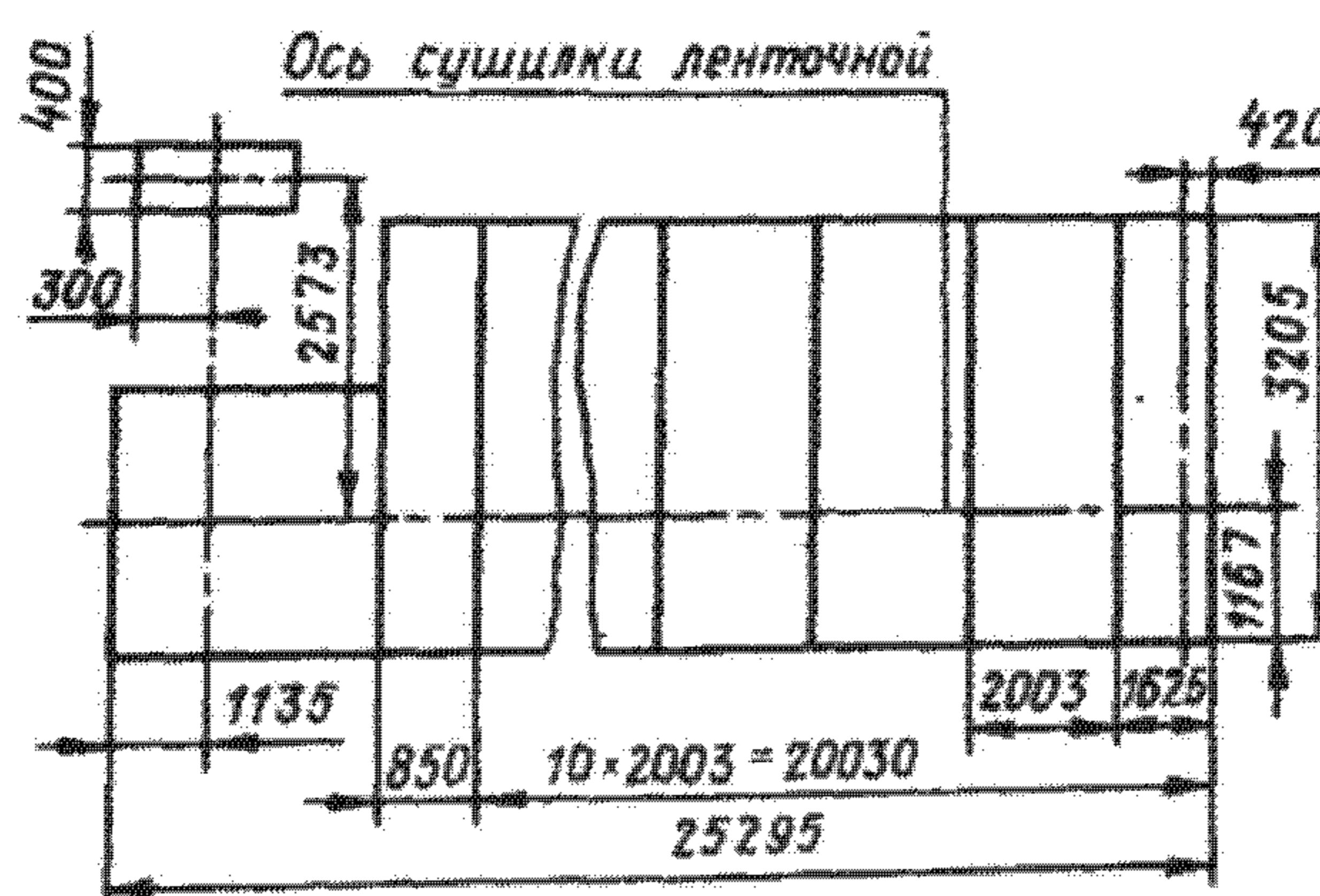
Рис. 34.9. Габаритные размеры опорных частей гранулятора, устанавливаемых на фундамент
